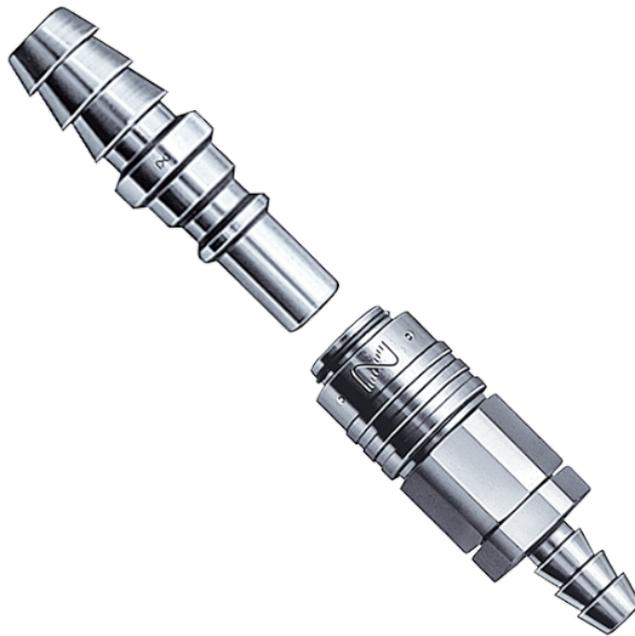
快速接头是一种不需运用工具就能完成敏捷拆装的管接头，它具有布局紧凑、体积小、重量轻、耐高温、可交换等长处，这种快速接头运用轻盈灵活、干净利落、在急需频繁拆装管路中运用尤为突出。那么如何正确选用快速接头呢？1. 根据流体的种类和温度来确定接头。流体的种类和温度对快速接头的使用质量有很大影响，因此在选用时要因地制宜。若流体是空气的，则可选用钢铁材质的快速接头，若流体是液体，则可选用黄铜的或者不锈钢材质的快速接头。2. 根据流体的压力选用合适的接头。流体的压力也是选定不锈钢快速接头的关键，不同构造的接头耐压程度是不相同。板把式快速接头供应报价快速接头适用于很多行业，所以每个行业中的快速接头都是不同的。
